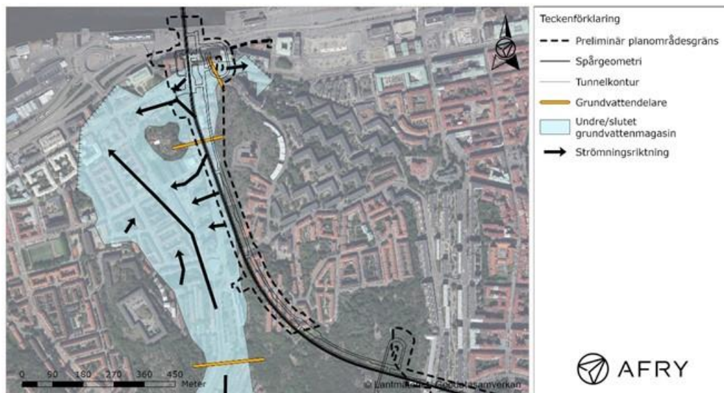
Figur 7. Konceptuell hydrogeologisk modell visande det undre grundvattenmagasinet utbredning, grundvattendelare och strömningsmönster. Slottsskogen ingår i preliminär planområdesgräns, men redovisas ej i kartan.
