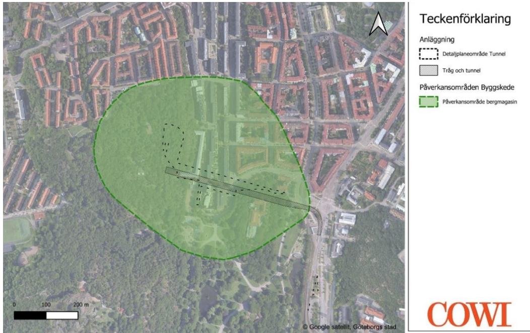
Figur 17. Preliminärt påverkansområde i berg i byggskede. Påverkansområdets rand definieras för en grundvattenavsänkning på 1,0 m. Hela Delsträcka Linné ingår i preliminär detaljplanområdesgräns, men redovisas ej i kartan.
